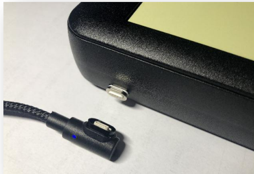
Foto 1.2.2.1: Hinterseite des Lecktestgeräts mit zero-force Anschluss
