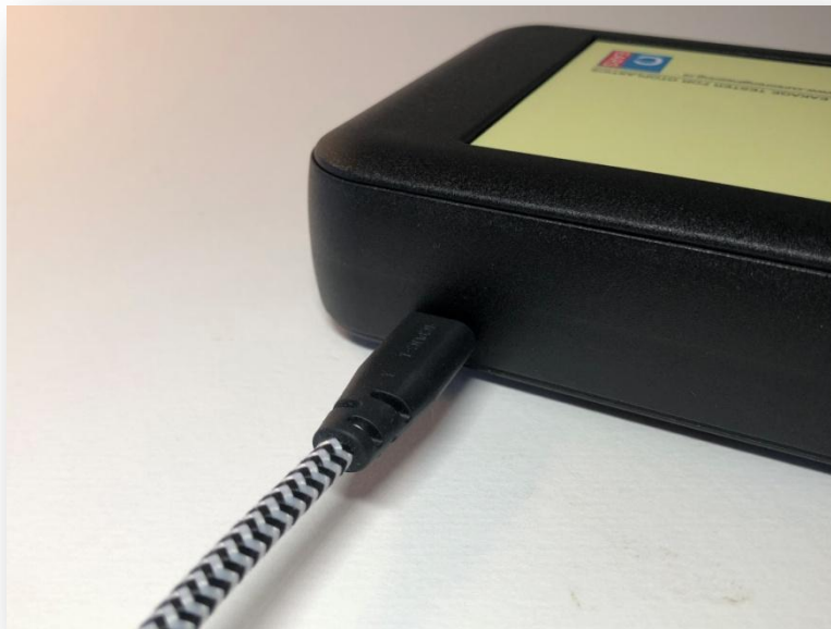
Foto 1.2.1.2: Rückseite des Lecktestgeräts mit angeschlossenem USB-C Kabel
