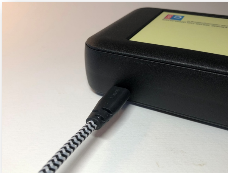
Foto 1.2.1.2: achterzijde van de lektester met USB-C kabel
