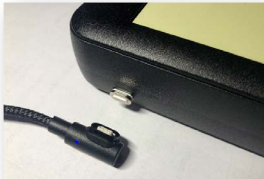
Foto 1.2.2.1: achterzijde lektester met magnetische zero-force connector
