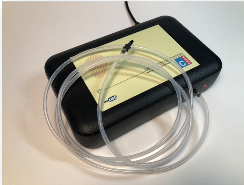
Foto 1.1.1: de USB lektester, front met siliconenslang en standaard adapter
